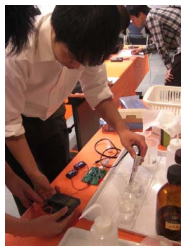
pH 電極と自分で作成した回路を使って緩衝液の pH 測定
